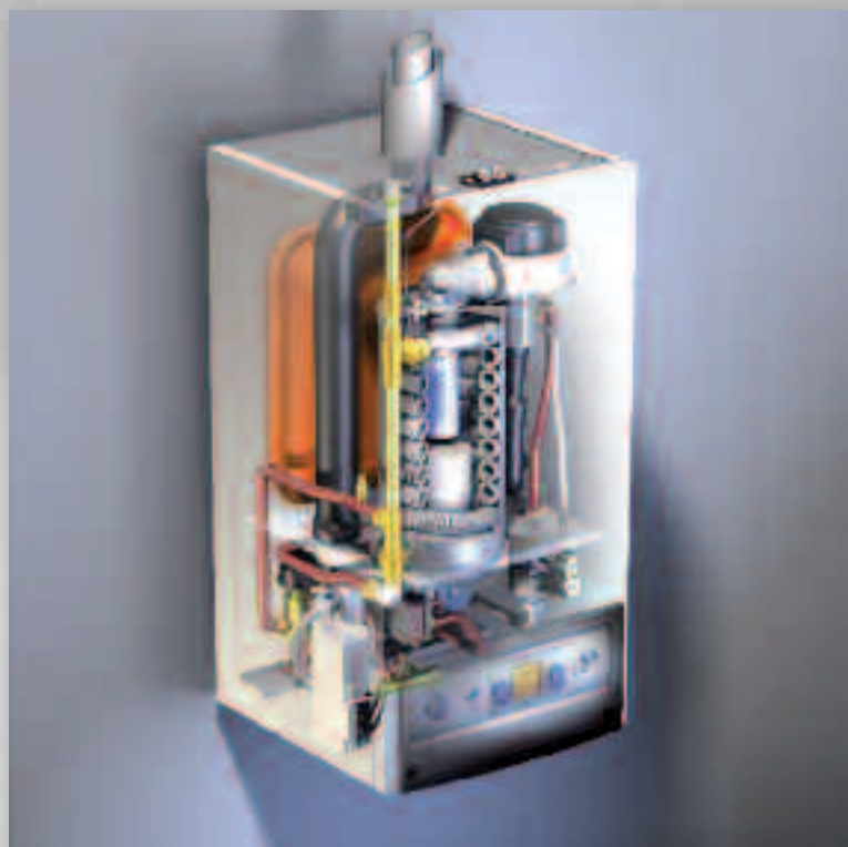
Schnittbild Gas-Brennwertgerät ComfortLine CGB
